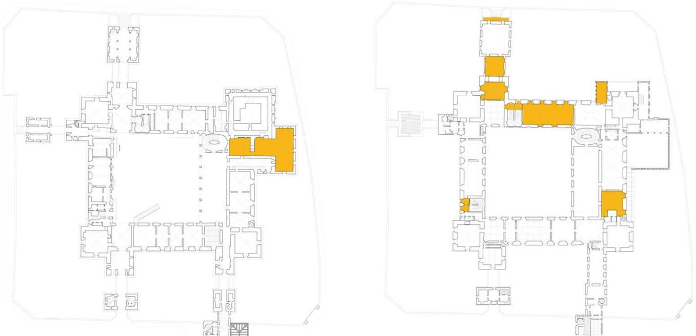
**Figura 27** - piano terra e piano primo: locali critici per asimmetrie radianti
